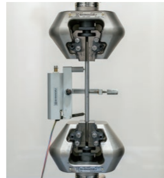
試験中のPC鋼棒
